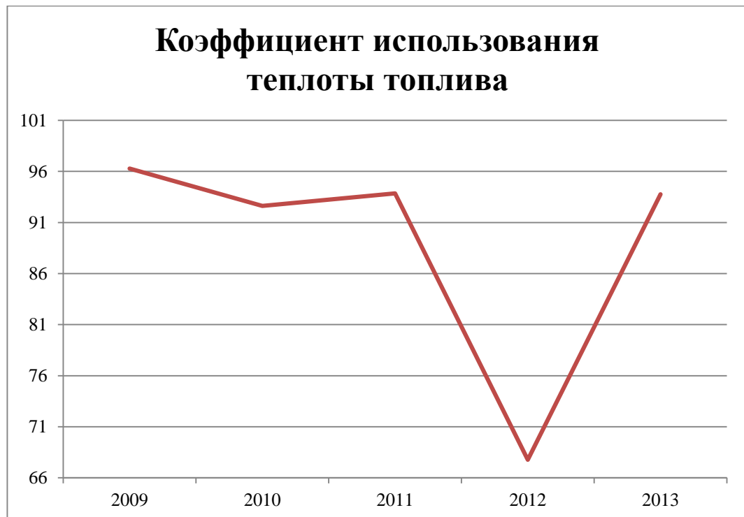
Рисунок 1 - Изменение коэффициента использования теплоты топлива
